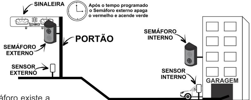
**BLOQUEIO DOS SENSORES:** No controlador de semáforo existe a características bloqueio dos sensores, quando um dos sensores (interno ou externo) for acionado primeiro o outro será bloqueado até que o tempo programado termine.
