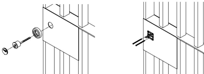
**Atención:** para la posición correcta del LED que está en el cilindro, debe estar alineado con la perforación de la tapa plástica del cilindro.
