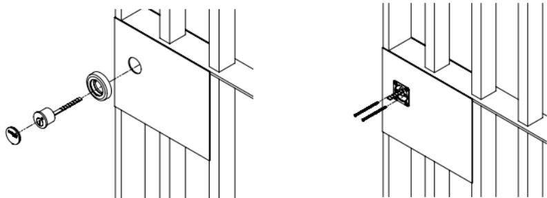
**Atenção:** para a posição correta do LED que esta no cilindro, ele deve estar alinhado com a furação da tampa plástica do cilindro.
