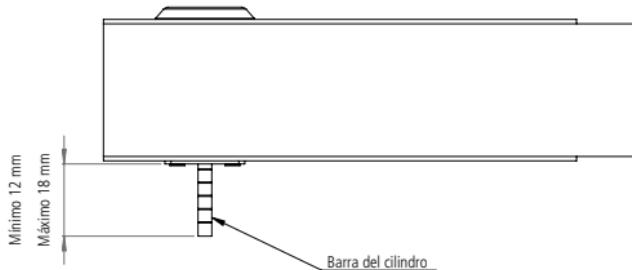
La misma cantidad de material retirado de la barra debe retirarse del tornillo. Para ello, mida las piezas según la siguiente imagen y realice el corte.
