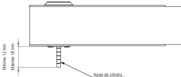
A mesma quantidade de material retirada da haste deve ser retirada do parafuso.
